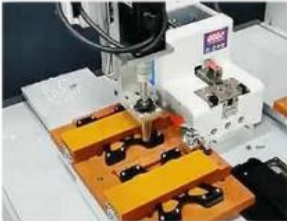
散热底座锁螺丝
